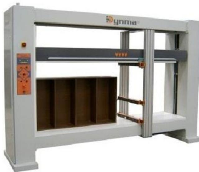
Figura 4.33. Prensa neumática de muebles modelo del caso de estudio 6.
