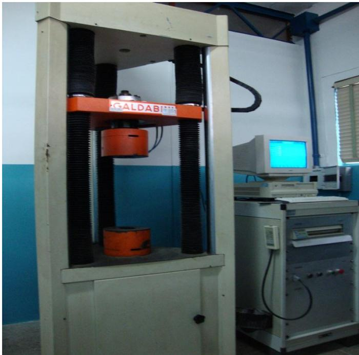
**Figura 5.1.** Máquina de ensayo universal Galdabini.
