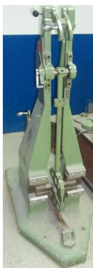
Figura 3.6 Máquina de ensayo de dureza
