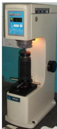
Figura 3.4 Máquina de ensayo de dureza
