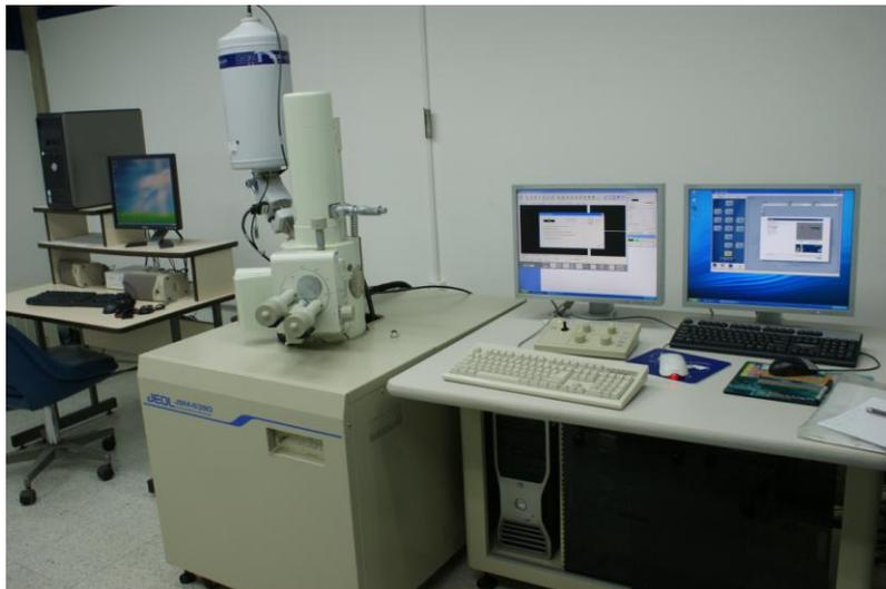
Figura 3.8 Microscopio electrónico de barrido
