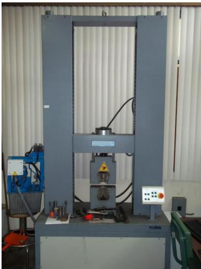
Figura 3.5 Máquina de ensayo de tracción
