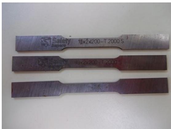
Figura 4.3 Probetas de tracción de acero para herramientas T.2000
