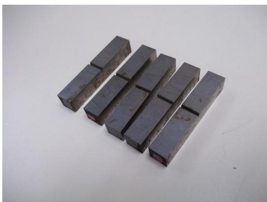
Figura 4.13 Probetas de impacto de acero para herramientas T.2000
