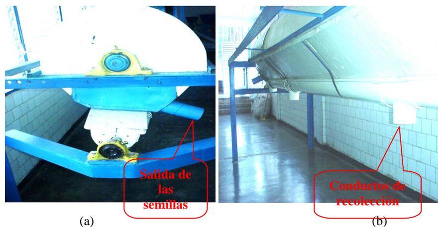
Fig. 1.2.1.2.3 Conductos de extracción de semillas de la máquina limpiadora y conductos de extracción del polvo
