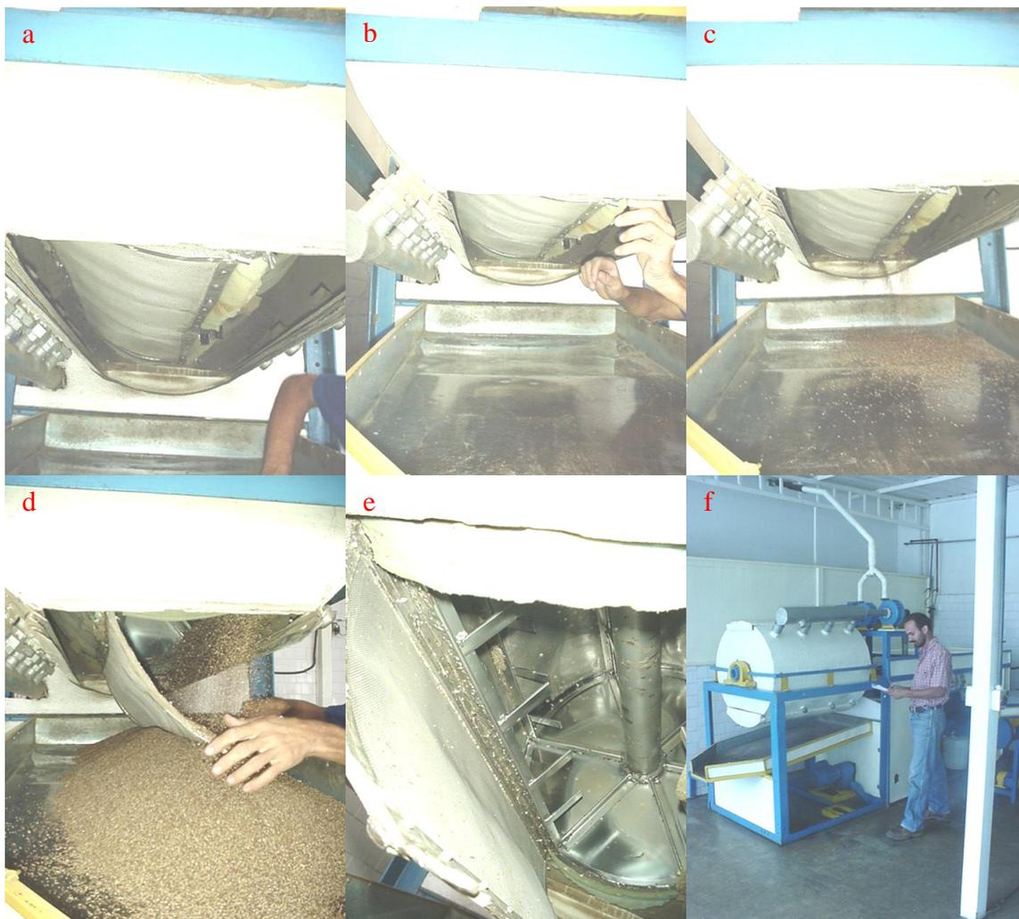
Fig. 1.2.1.3.10 Secuencia del proceso de descarga de las semillas
