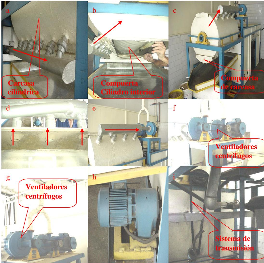
Fig. 1.2.1.3.9 Secuencia del flujo de aire caliente
