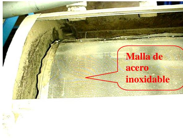
Fig. 1.2.1.3.3 Cilindro interior de la deshidratadora
