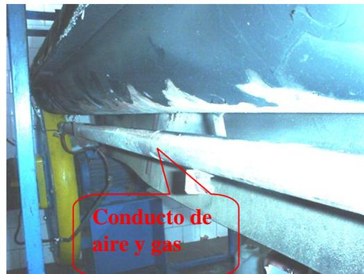
Fig. 1.2.1.3.7 Conducto de aire y gas para la transferencia de calor
