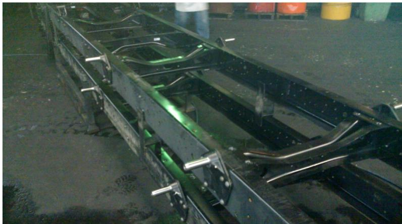
Figura 2.1 Chasis con Estructura Convencional tipo Escalera.
