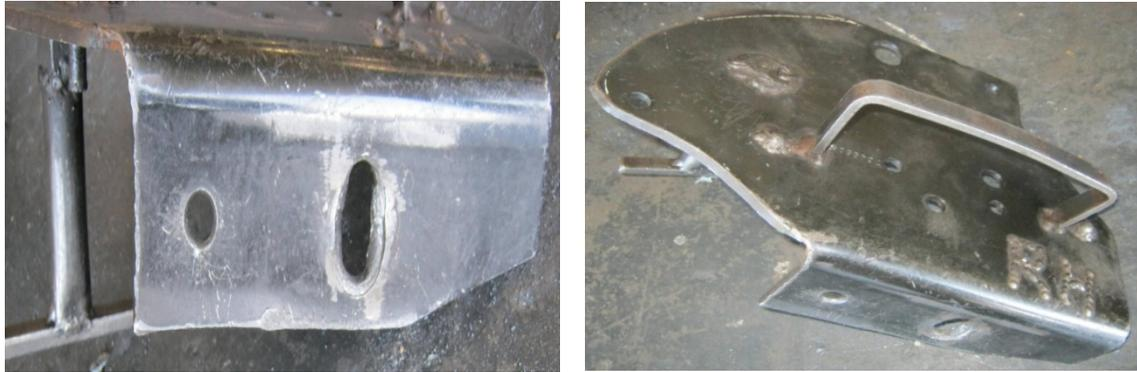
Figura 4.4: Plantilla de Perforación para Pestaña Inferior.
