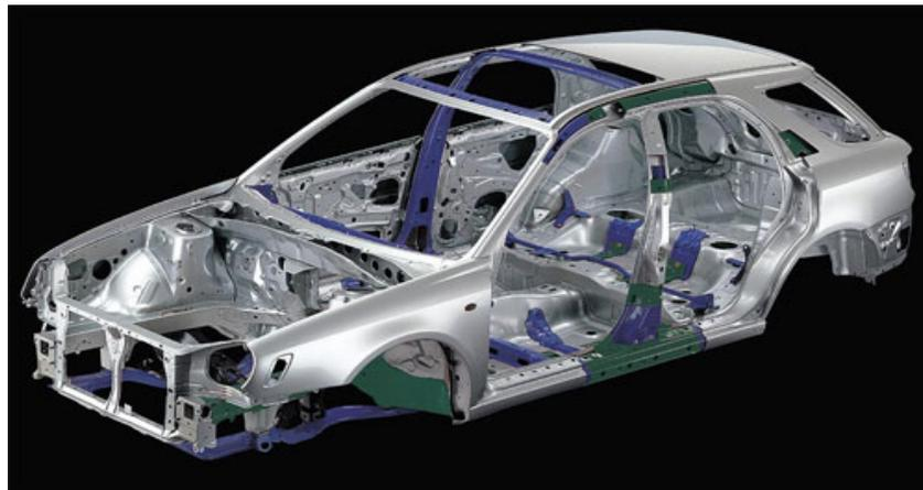
Figura 2.3 Estructura Monocasco.
