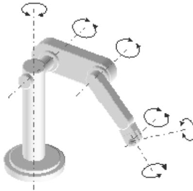
Figura 2.18 Grados de Libertad de un brazo de Robot.
