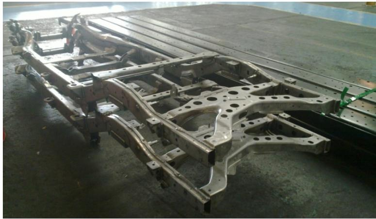
Figura 2.2 Chasis con Estructura Convencional tipo Perimetral.
