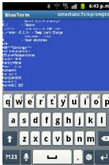
Figura 4.10 Configuración de los comandos del módulo bluetooth.
