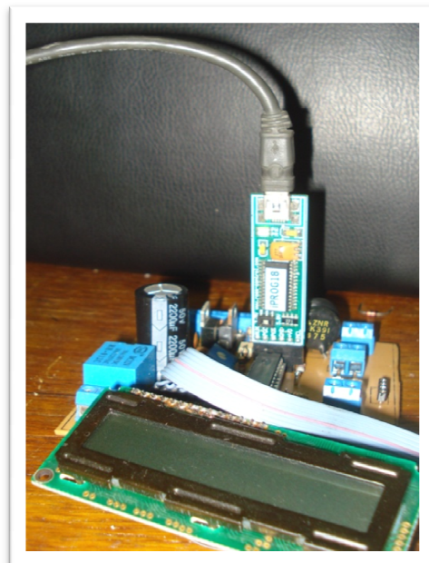
Foto 6. Pantalla LCD y programador para el PIC.
