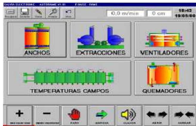
Figura 2.19. Ejemplo de un Sistema SCADA
