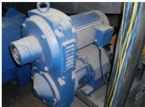
Figura 4.8. Motor (M401) Transportadora
