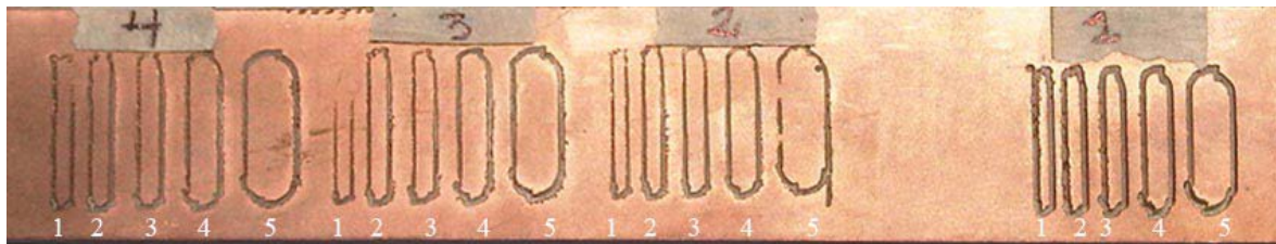
Figura 4.10.3 Pruebas de pistas en la lámina PCB
