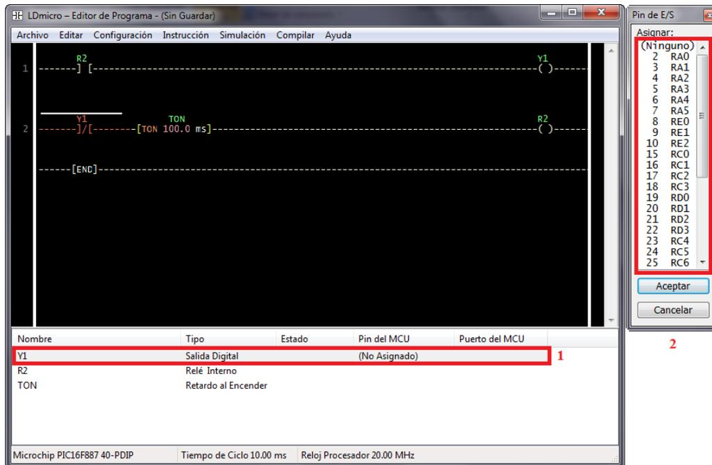
**Figura 2.18 Configuración de los Terminales Entrada/Salida del LDmicro.**
