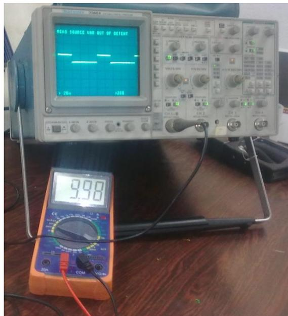
**Figura 4.24** Montaje de Pruebas PLC – Interfaz de Salida de Corriente.
