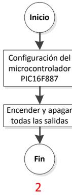
**Figura 4.22** Diagrama de los algoritmos usados para las pruebas de las entradas y salidas Digitales del PLC887.
