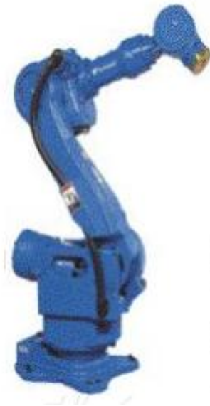
Fig. 2.3. Estructura de un robot de 6 grados de libertad.
