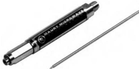
Figura 3.1: Línea coaxial de aire comercial. [20]
