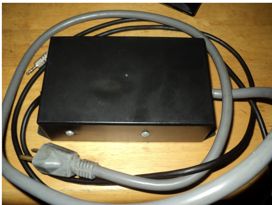
Figura 4.19 - Caja del transformador de alimentación
