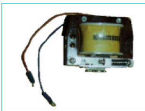
Figura A.4: Bobina de Potencial de un Medidor Electromecánico. Fuente: Amner de Paz y Hipólito León. [28]
