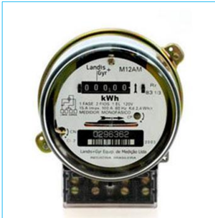
Figura 2.5: Medidor Electromecánico. Fuente: Paz y León (2007). [28]
