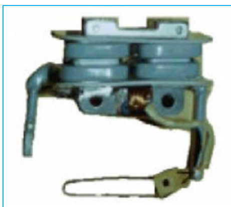
Figura A.5: Bobina de Corriente de un Medidor Electromecánico. Fuente: Amner de Paz y Hipólito León. [28]
