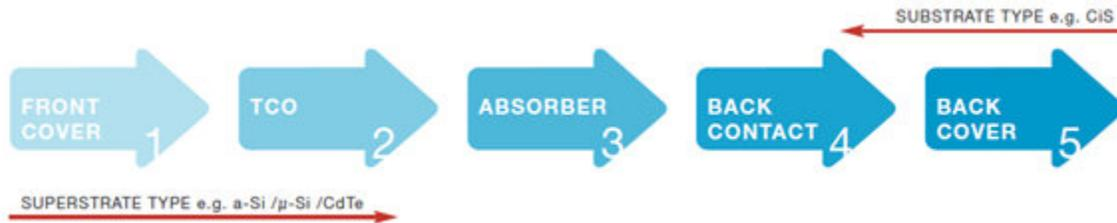
**Figura 2.11** Proceso de fabricación de las celdas de película delgada. Fuente: EPIA [6].
