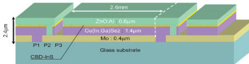
Figura 4.11 Vista de corte transversal de una celda de CIGS. Fuente: K. Matsunaga [42]
