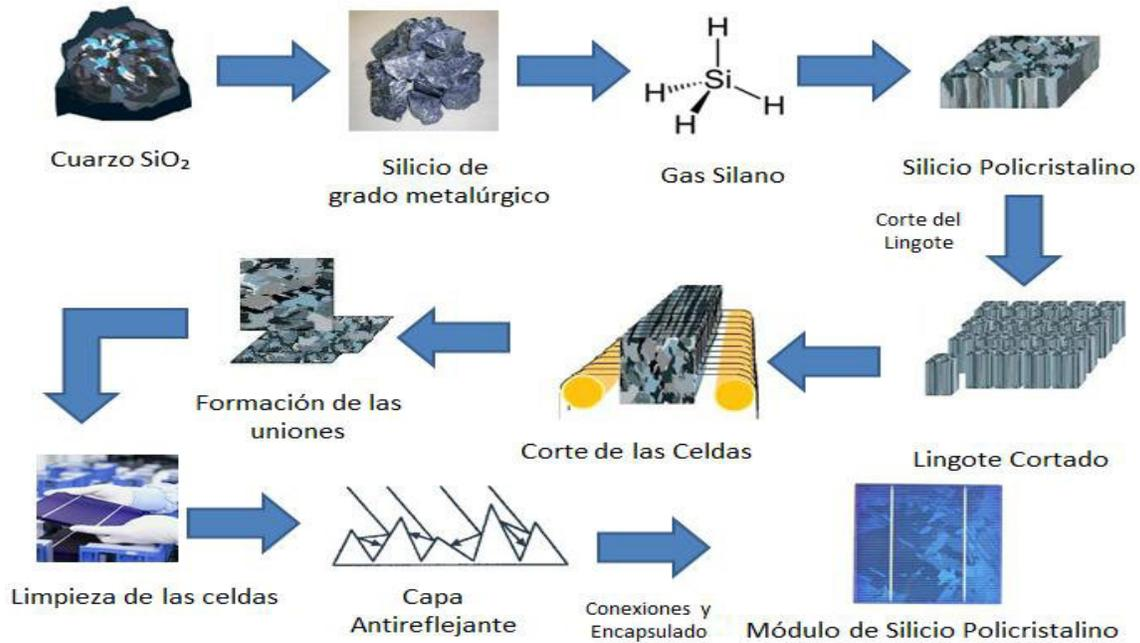
Figura 4.21 Etapas del Proceso de Fabricación de las celdas de Silicio Policristalino. Fuente: Arráz O. y Santos A. (2013).
