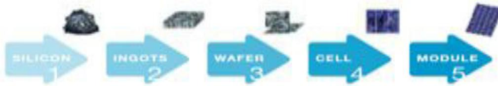
**Figura 2.8** Proceso de fabricación de las celdas de silicio cristalino. Fuente: EPIA [6].
