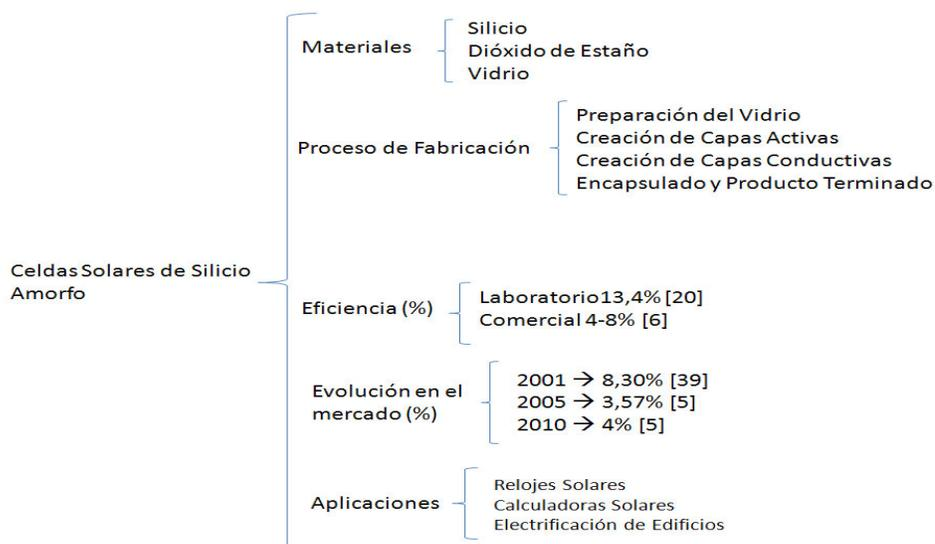
Figura 4.8 Resumen de las celdas solares de Silicio Amorfo.
