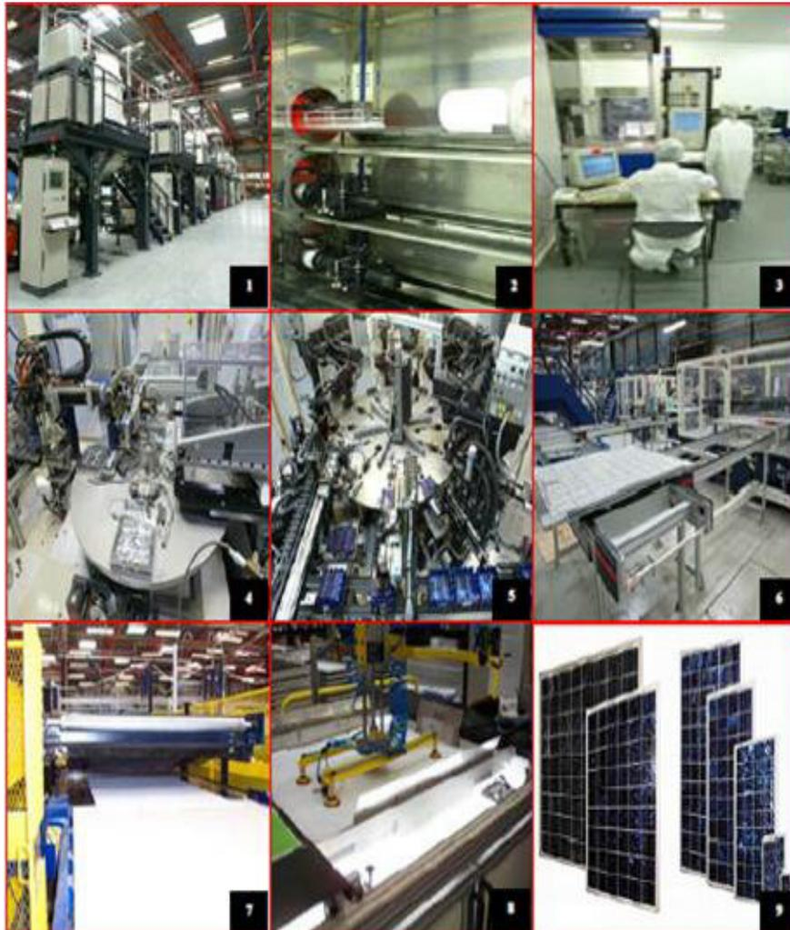
**Figura 2.10** Proceso de fabricación de paneles solares fotovoltaicos policristalinos de silicio. Fuente: A. Figueroa [23].
