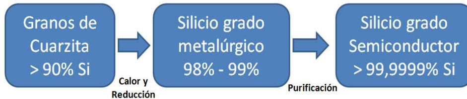
**Figura 4.3 Producción del silicio de alta pureza a partir de Cuarzita.**
