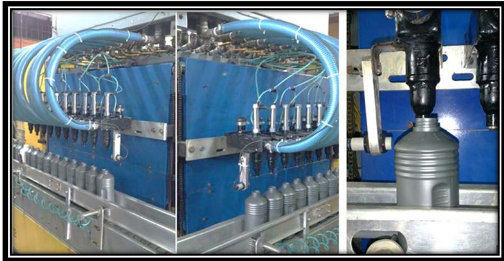
Figura 4.38 Sensores capacitivos instalados para detectar el nivel
