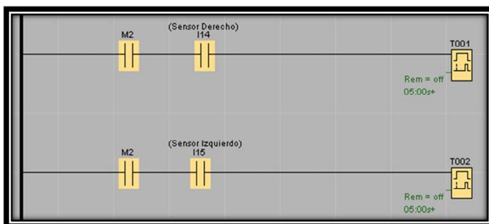
Figura 4.26 Configuración ladder (Tiempo de espera de la banda)
