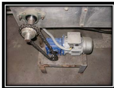
Figura 4.40 Motor añadido para la banda derecha
