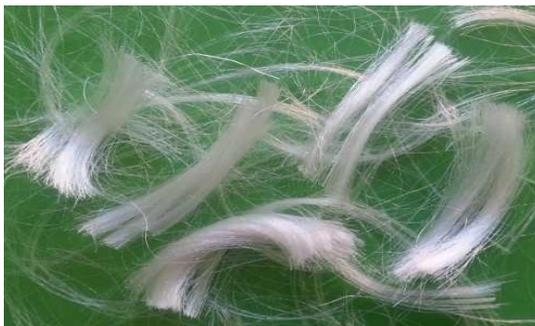
**Figura 7. Fibras de Polipropileno.**
