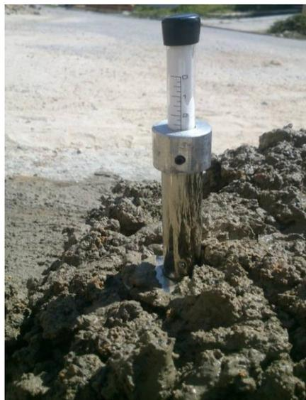
**Figura 14.** *Medición de Asentamiento.*
