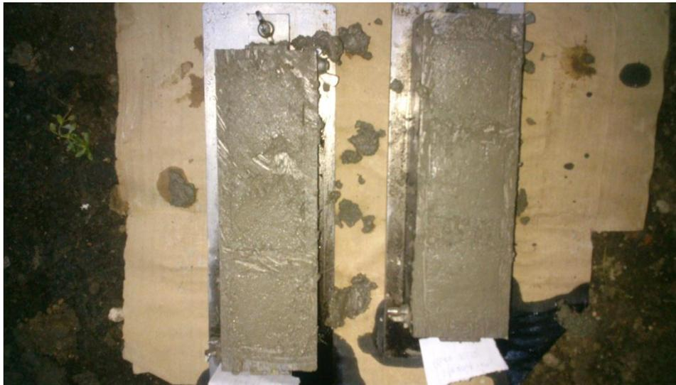
**Figura 9.** *Moldes de probetas cúbicas (Vaciadas).*
