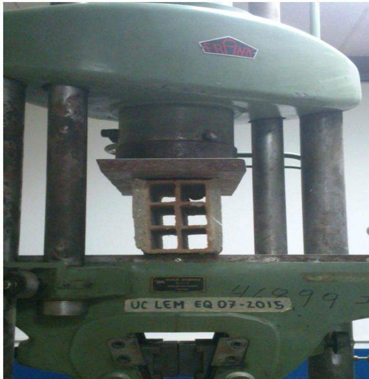
**Figura 17.** *Ejemplo de colocación de bloque en Máquina.*
