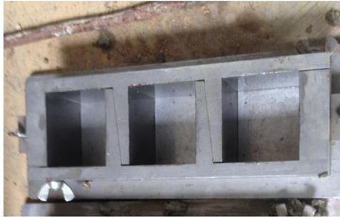
**Figura 8.** *Molde típico de probetas cúbicas (Sin vaciar).*
