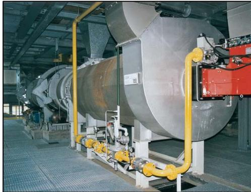
**Figura No 4.27.** Horno Rotatorio Seleccionado (Modelo DOUBLE SHELL DRYER)
