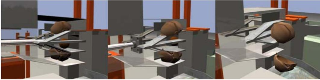
**Figura No 4.10.** Secuencia de la expulsión de la fibra del coco.
