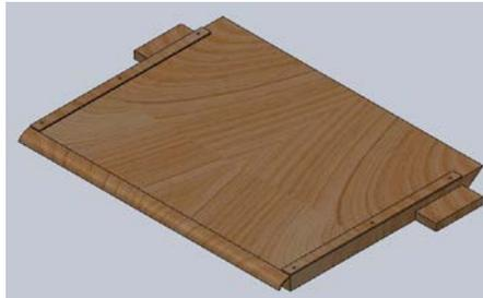
**Figura 4.6** Alternativa de solución 2 para los problemas de la bancada.
