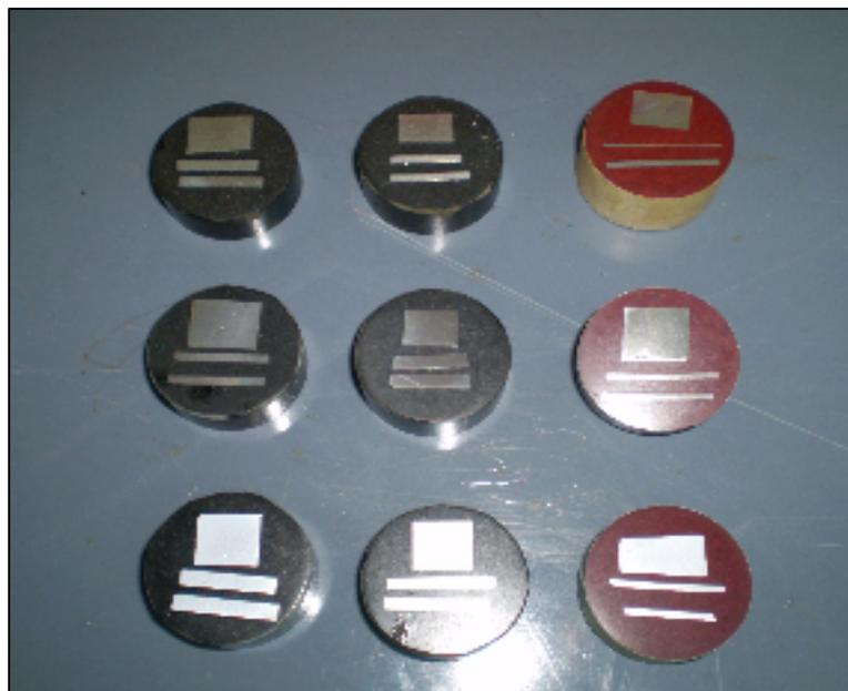
Fig. 3.2 Probetas embutidas
