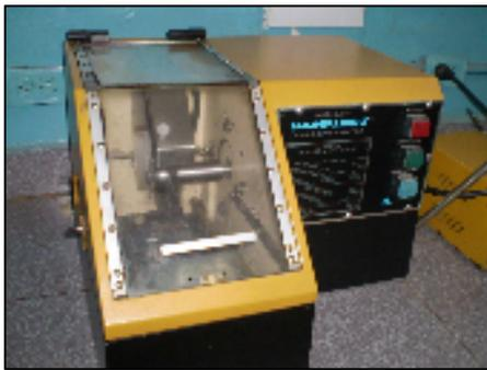
Fig. 3.8 Cortadora metalográfica.
