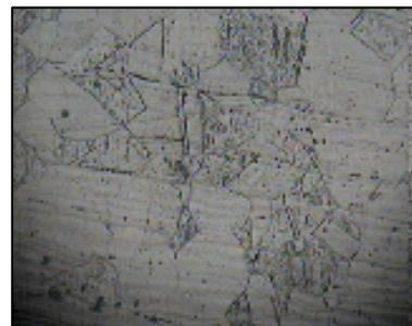
Fig 4.18. Microscopía de Optica para Acero 304 de 2 mm. de espesor, con 400X.
