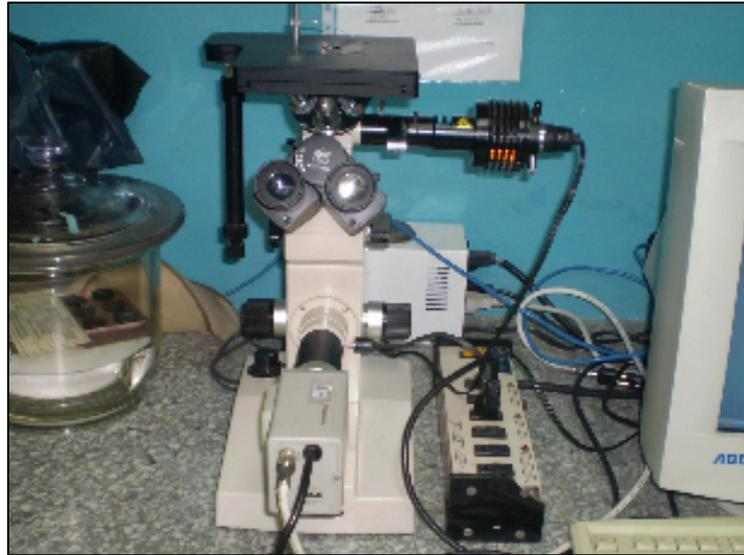
Fig. 3.1 Microscopio óptico.
