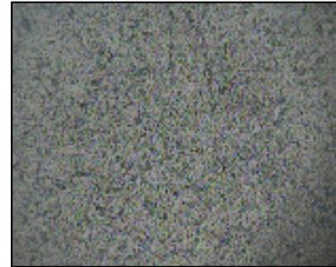
Fig 4.2. Microscopía de Optica para Aluminio 3003 H14 de 1.5 mm. de espesor, con 400X.
