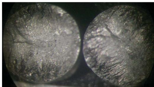
**Figura 4.21** Fotografía de la superficie de fractura de la muestra N° 12 en ácido nítrico al 15% con 85% del esfuerzo de fluencia tomada sobre el portamuestras con una cámara digital a través de un estereoscopio
