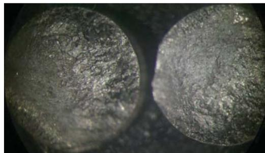
**Figura 4.11** Fotografía de la superficie de fractura de la muestra N° 14 en aire con 85% del esfuerzo de fluencia tomada sobre el portamuestras con una cámara digital a través de un esteroscopio
