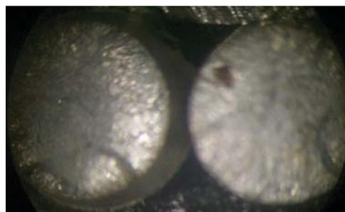
*Figura 4.14 Fotografía de la superficie de fractura de la muestra N° 23 en aire con 75% del esfuerzo de fluencia tomada sobre el portamuestras con una cámara digital a través de un estereoscopio*
