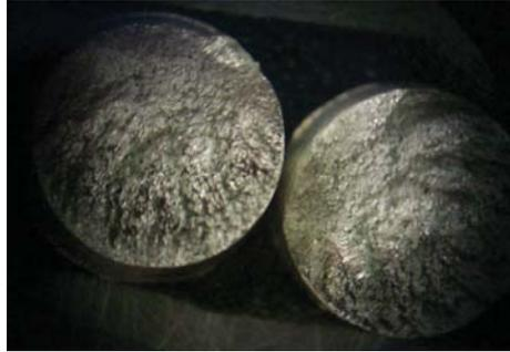
**Figura 4.7** Fotografía de la superficie de fractura de la muestra número 5 en aire con 95% del esfuerzo de fluencia, tomada sobre el portamuestras con una cámara digital a través de un estereoscopio.
