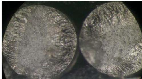
*Figura 4.9* Fotografía de la superficie de fractura de la muestra N° 8 en aire con 90% del esfuerzo de fluencia tomada sobre el portamuestras con una cámara digital a través de un estereoscopio.
