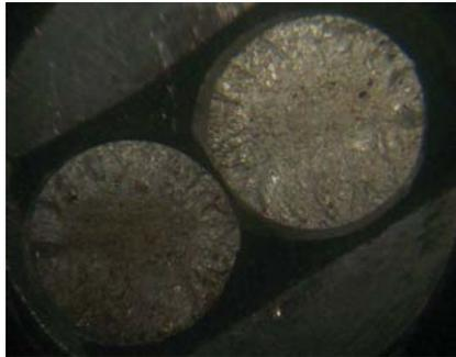
**Figura 4.17** Fotografía de la superficie de fractura de la muestra N° 2 en ácido nítrico al 15% con 95% del esfuerzo de fluencia tomada sobre el portamuestras con una cámara digital a través de un estereoscopio
