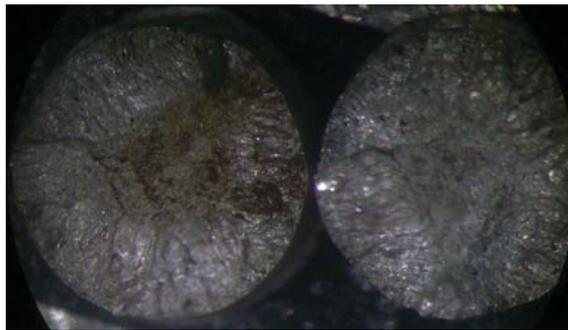
**Figura 4.19** Fotografía de la superficie de fractura de la muestra N° 7 en ácido nítrico al 15% con 90% del esfuerzo de fluencia tomada sobre el portamuestras con una cámara digital a través de un estereoscopio
