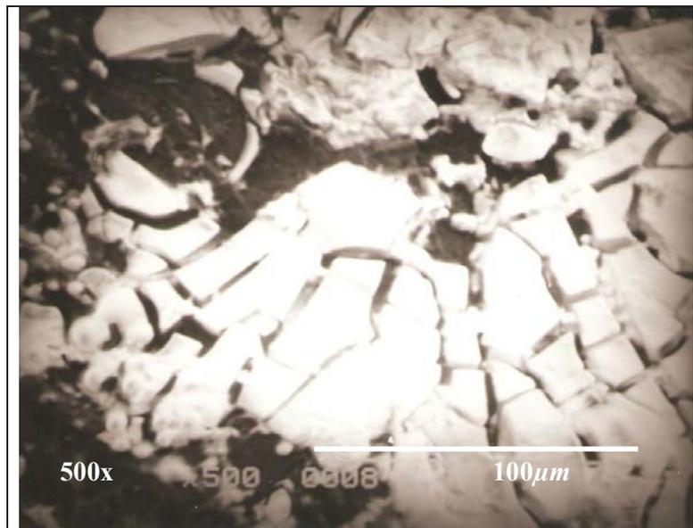
**Figura 4.20** MEB de la muestra N° 7 en ácido nítrico al 15% con 90% del esfuerzo de fluencia con acercamiento de 500x y 100 $\mu$ m.
