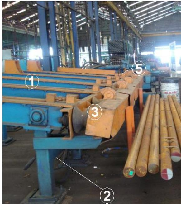
Fig. 4.1: Plataforma de alimentación y contenedor de barras de acero.
