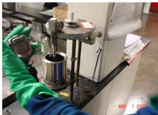
Figura B.18. Arranque de la toma de la medida del tiempo que tarda en completarse una revolución
