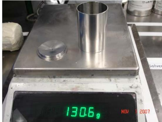
Figura B.12. Pesada del picnómetro vacío y tapa
