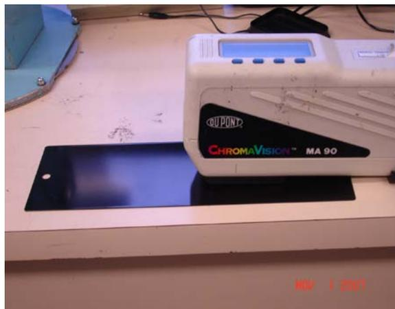
Figura B.3 Medición del color de un sustrato metálico con el Crhoma Vision (10°)
