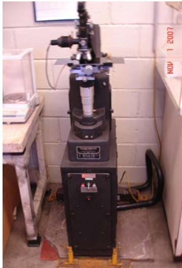
Figura B.20. Equipo utilizado para la medición de la dureza Tukón
