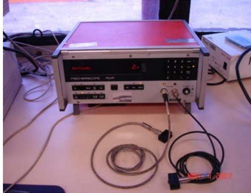
Figura B.1 Medidor de espesor Fisherscope Multi 750
