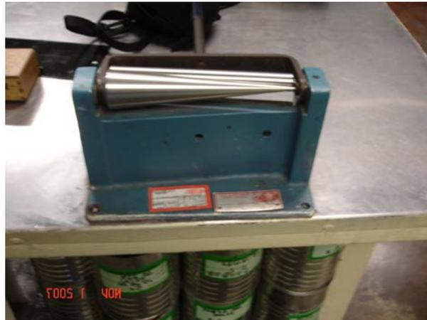
Figura B.4 Mandril cónico para pruebas de flexibilidad
