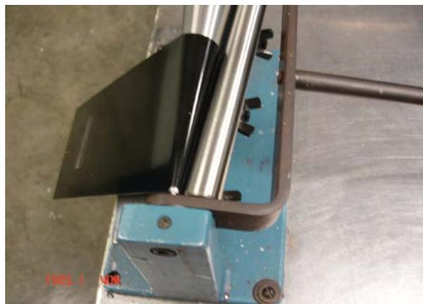
Figura B.5 Vista de una lamina a la que se le ha aplicado la prueba de flexibilidad
