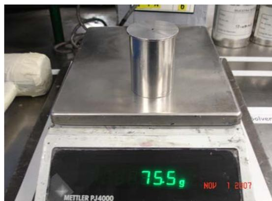
Figura B.14. Pesada de la muestra una vez que se taró la balanza
