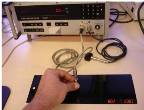
Figura B.2 Medición del espesor de sustrato metálico
