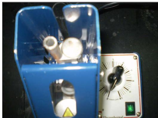
**Figura A.19:** Perilla reguladora del Fusiómetro Electrothermal MEL - TEMP
