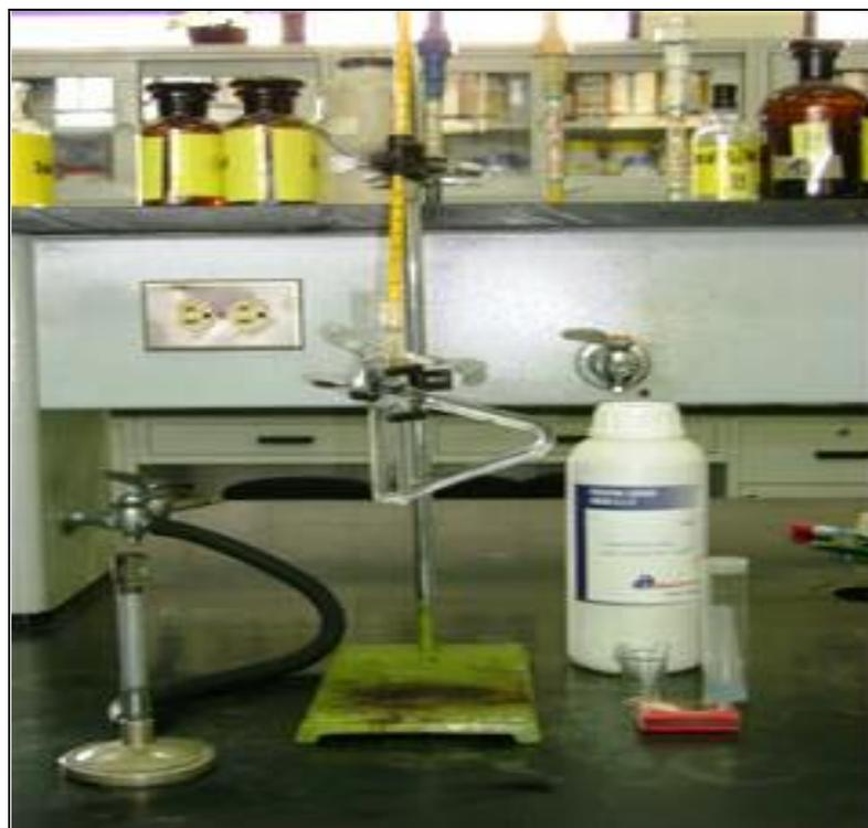
**Figura A.21:** Montaje del equipo para determinar el punto de ebullición
