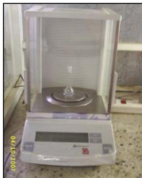
**Figura A.10:** Pesaje del balón aforado en la balanza analítica
