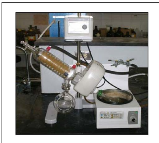
**Figura 3.24:** Rotaevaporador empleado para la recuperación de solventes.
