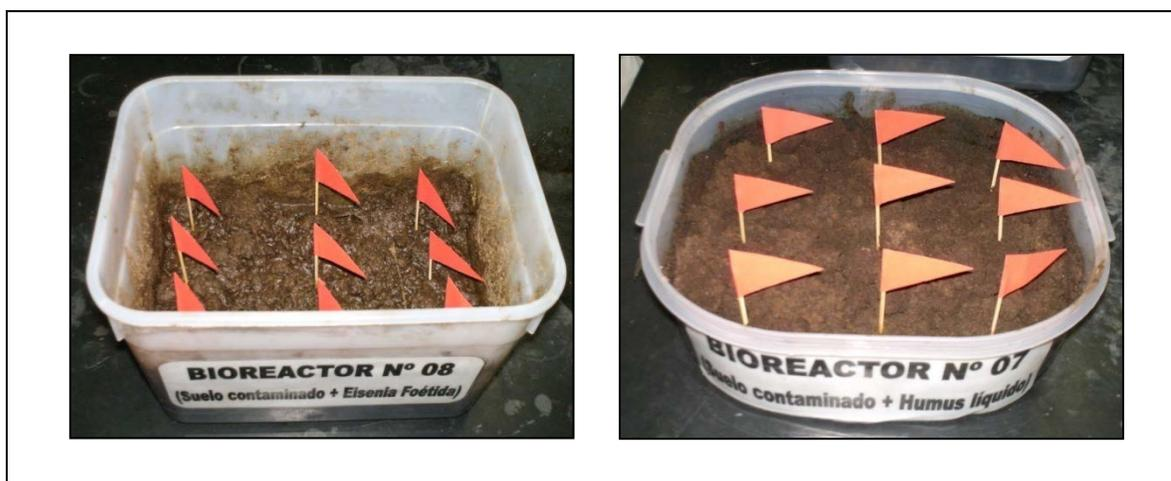
**Figura 3.19:** Método de muestreo para obtener una muestra compuesta en cada biorreactor
