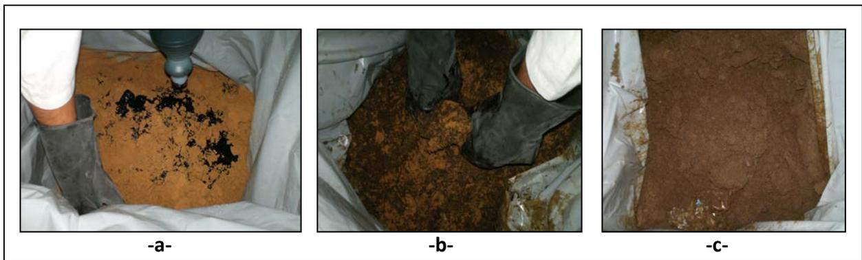
**Figura 3.16:** Preparación del suelo contaminado. -a-) Adición del crudo al suelo; -b-) Proceso de mezclado del crudo con el suelo encalado; -c-) Suelo contaminado
