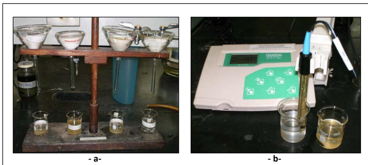
**Figura 3.37:** Determinación del potencial de acidez de las muestras de suelo. –a-) Proceso de filtración por gravedad; -b-) Mediación con el pH metro marca Oaklon modelo 510.
