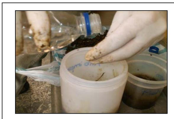
**Figura 3.12.** Adición de agua al sustrato o estiércol en los biorreactores a pre-escala
