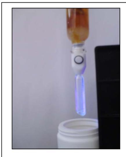
**Figura 3.34:** Elución de la fracción de compuestos aromáticos dentro de la columna
