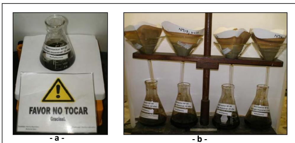
**Figura 3.27:** Obtención de asfaltenos. -a-) Etapa de precipitación con n-hexano p.a; -b-) Etapa de filtración
