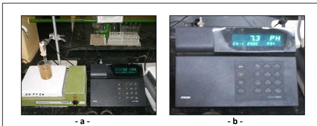
**Figura 3.5:** Determinación del potencial de acidez al suelo encalado. -a-) Medición del pH a la solución sobrenadante después de ser decantada; -b-) Valor arrojado por el pH-metro
