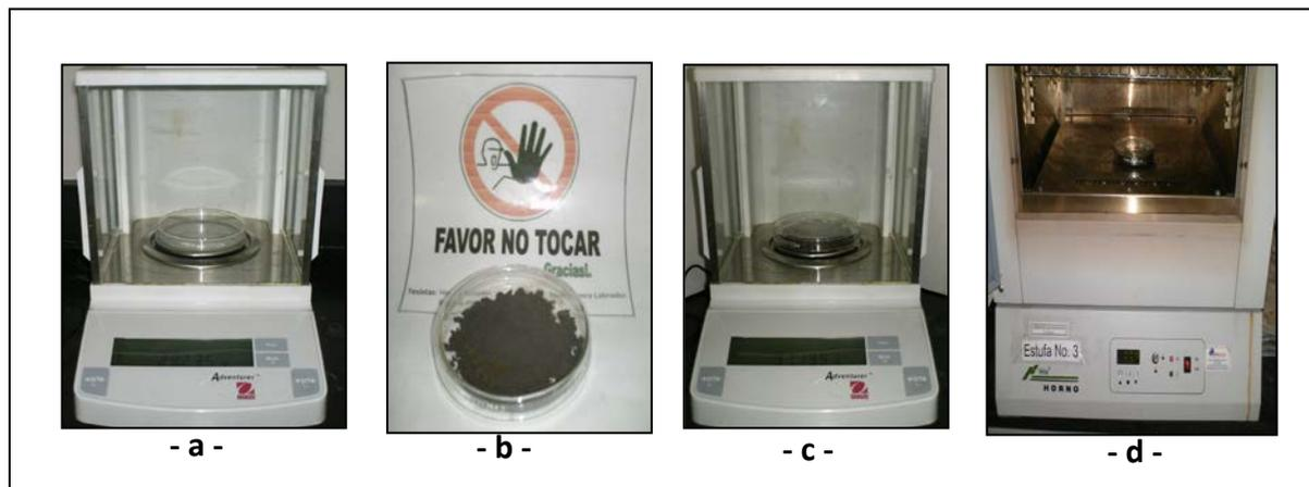
**Figura 3.38:** Determinación de humedad de la muestra de suelo. –a-) Pesada de la cápsula de Petri;-b-) Adición de aproximada de 20 g de suelo; -c-) Pesada de la muestra húmeda; -d-) Introducción de la muestra en la estufa por 12 horas.
