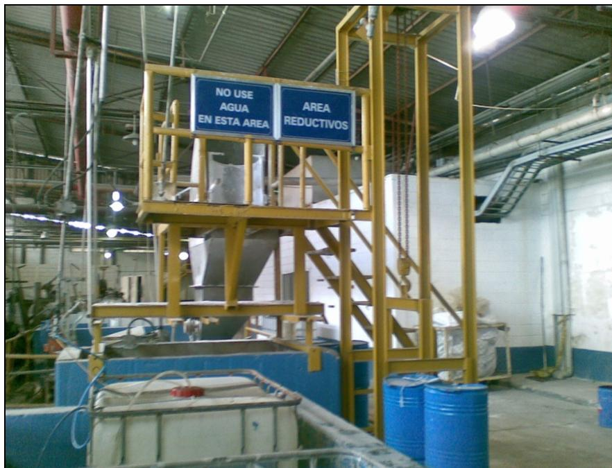
Figura 3.18 Preparación del hidrosulfito de sodio para el blanqueo reductivo
