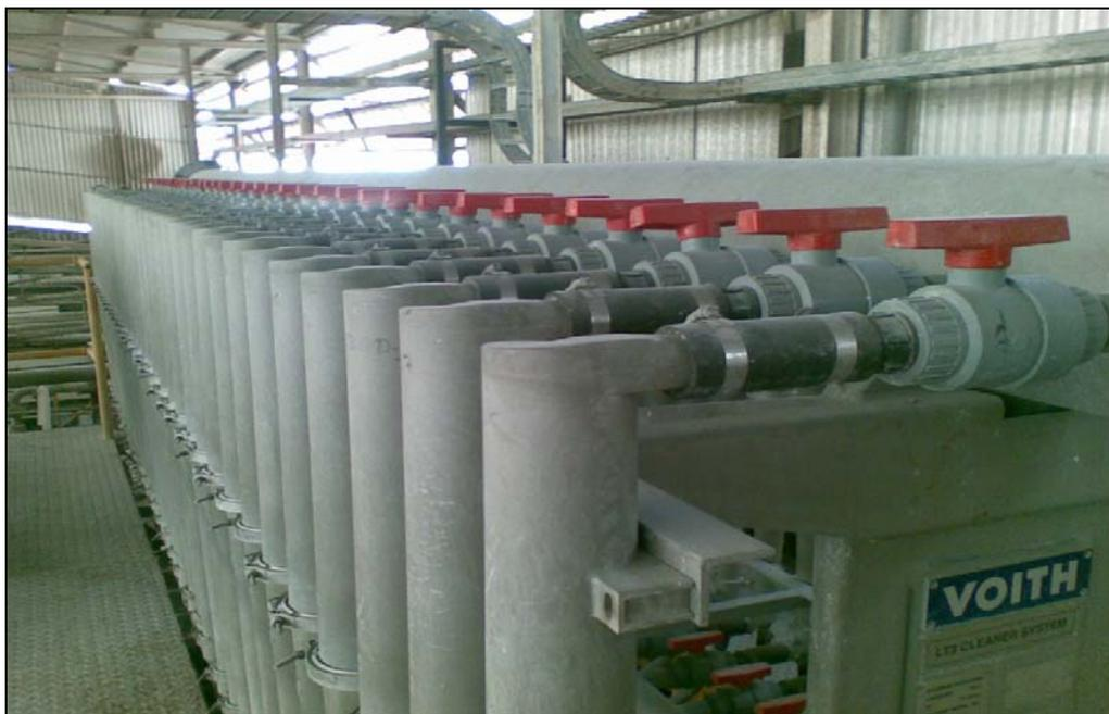
Figura 3.13 Banco de limpiadores reversos en la planta de destintado (LT3).
