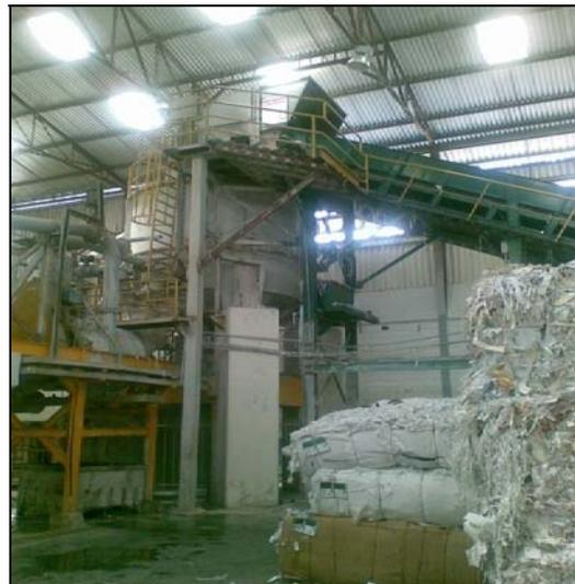
**Figura 3.3 Equipo desintegrador de la materia prima (Pulper N° 4).**
