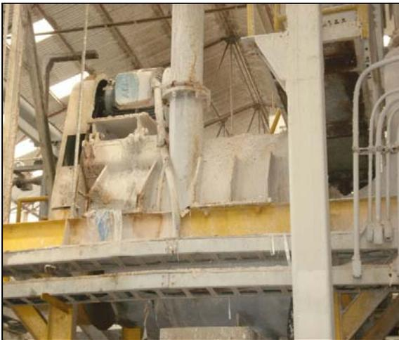
**Figura 3.4 Limpiador centrífugo (Contaminex).**
