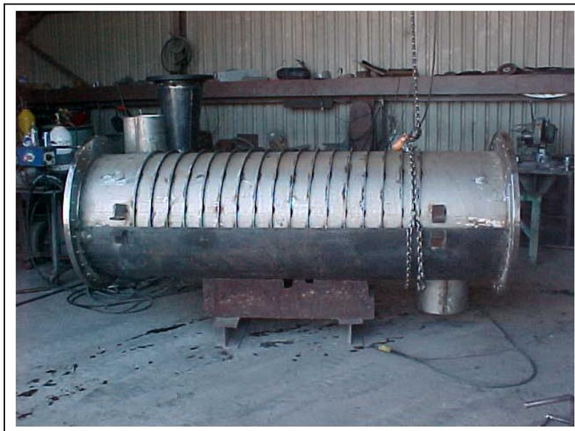
**Figura 4.4 Detalle de la chaqueta de los peletizadores de la unidad II**
