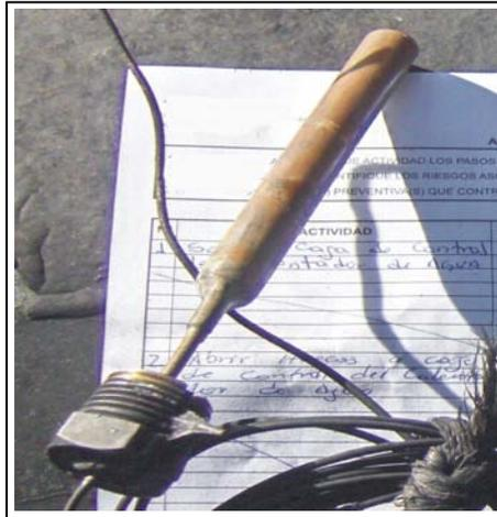
**Figura 5.16 Elemento sensor del sistema de control por temperatura**
