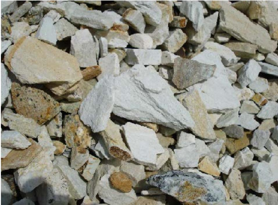
Figura anexo 1: Material ¾" (piedra picada) enviado a la sección de secado y molienda
