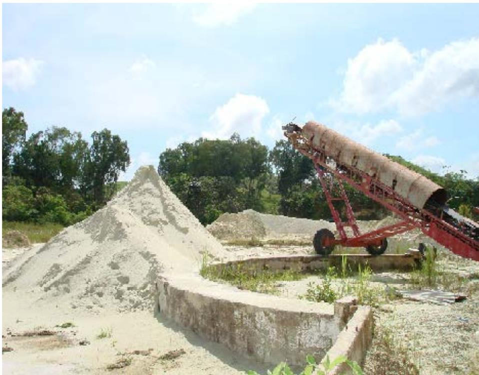
Figura anexo 6: Apilador Radial de la sección de molienda
