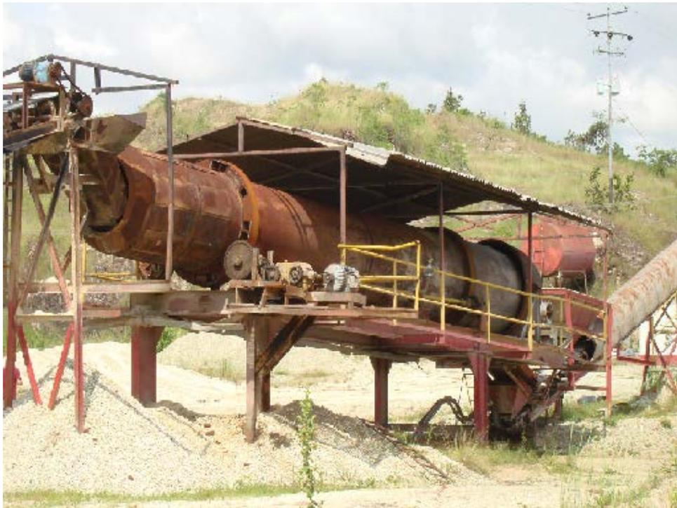
Figura anexo 4: Secador Rotatorio operando actualmente en la sección de secado
