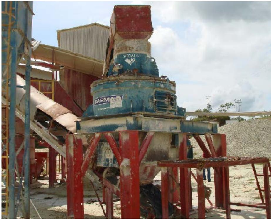
Figura anexo 5: Molino Barmac serie B7000 instalado en la sección de molienda
