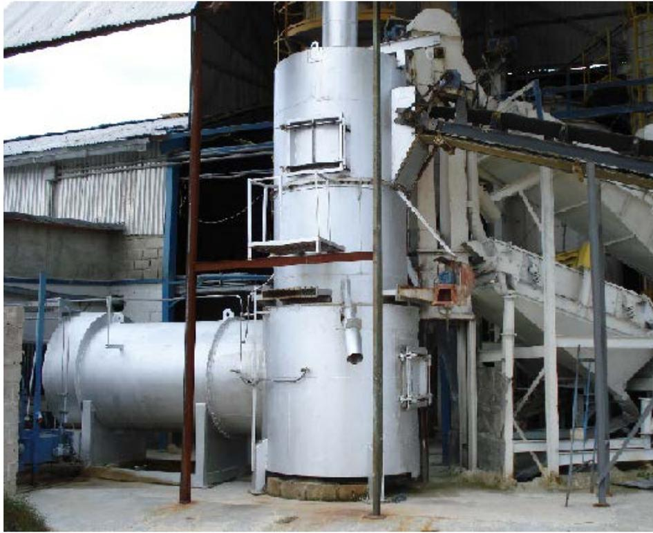
Figura anexo 7: Lecho Fluido instalado en la sección de clasificación
