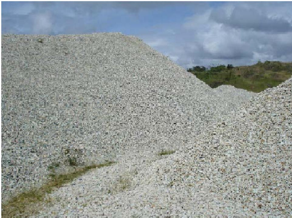
Figura anexo 2: Acumulación de material ¾" previo a la sección de secado
