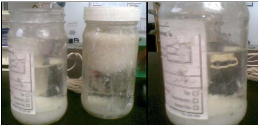
Figura 4.4. Efluente tratado en prueba de jarras 5 (reacción 48 horas después).
