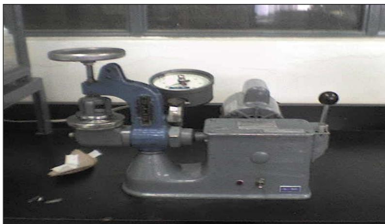
Figura 3.13. Equipo para la determinación de la resistencia al estallido.
