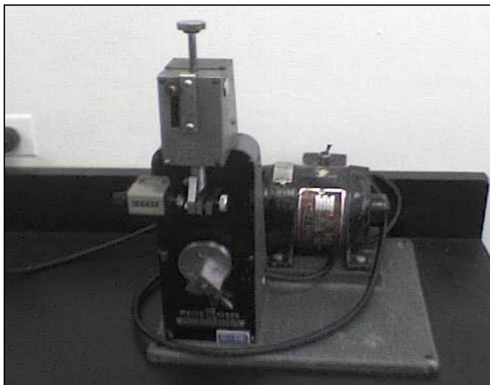
Figura 3.12. Equipo para la determinación de la resistencia al doblar.
