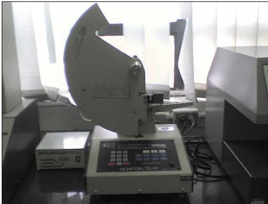
Figura 3.11. Equipo para la determinación de la resistencia al rasgado.
