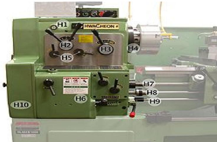
**Figura 2.6** Caja de velocidades y avances [Torno (2005). On-line]
