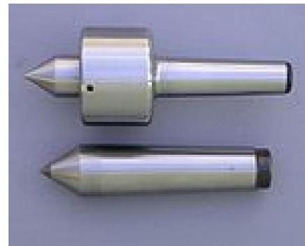
**Figura 2.9.** .Puntos de arrastre [Torno (2005). On-line]
