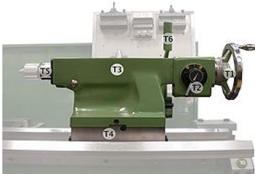
**Figura 2.4** Cabezal móvil [Torno (2005). On-line]
