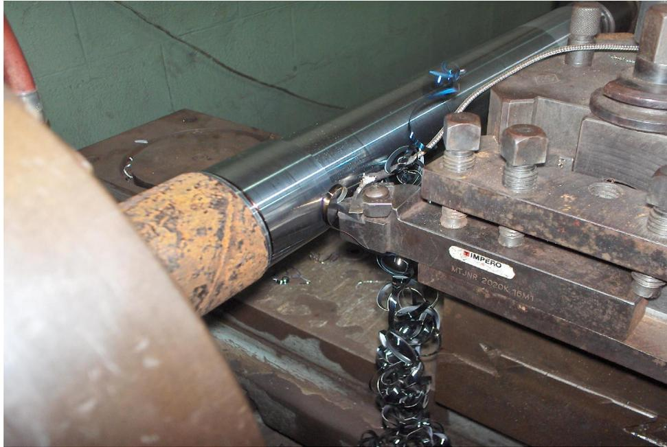
**Figura 3.3.** Proceso de mecanizado para observar la profundidad realizada en la barra cilíndrica
