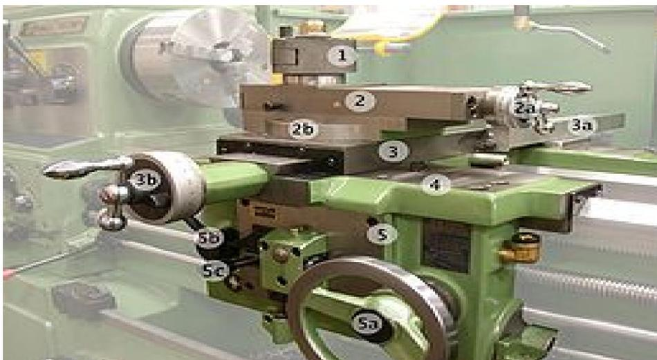
**Figura 2.5.** Carros portaherramientas [Torno (2005). On-line]
