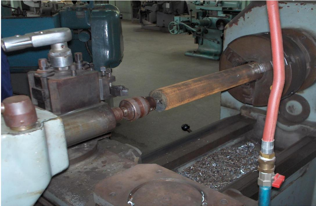
**Figura 3.8.** Montaje de una de barra cilíndrica a mecanizar(AISI-4140) [Fuente: Autores]
