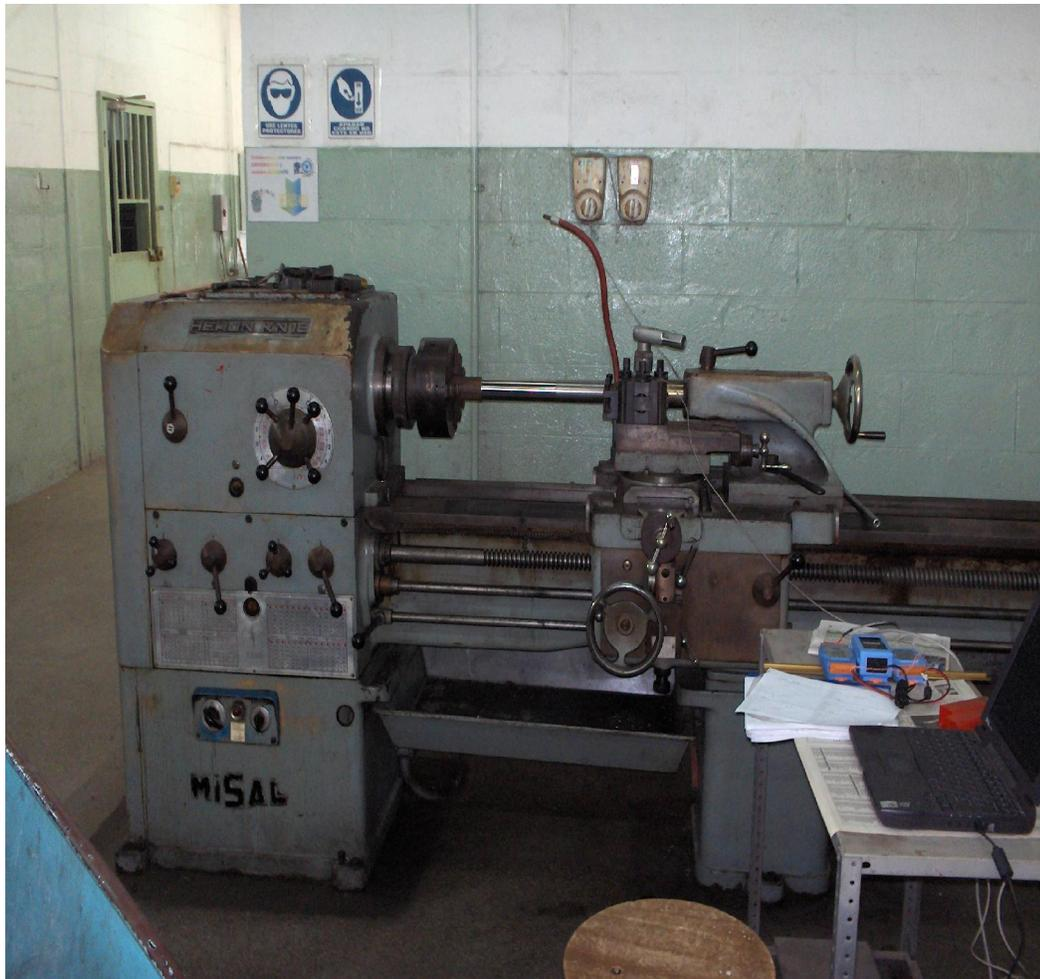
**Figura 3.7.** Torno utilizado en el ensayo y el equipo de medir la temperatura [Fuente: Autores]
