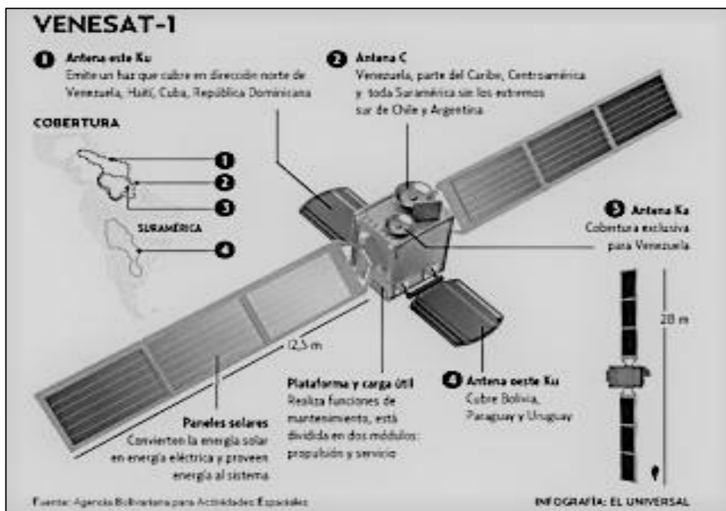
Gráfica 2. Modelo del Satélite Simón Bolívar. Diseño con la descripción del modelo. Fuente: González y Acosta (2017)
