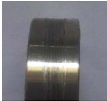
**Figura 4.12.** Probeta 14, carga 17,1 N, 5000 m (Medina y Peralta, 2010)
