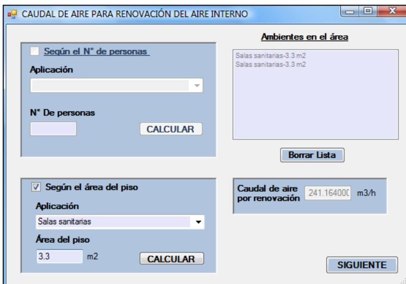
Figura N° 4.63 Volumen por aire de renovación del aire interior en baños (2<sup>da</sup> planta) mostrado por la herramienta
