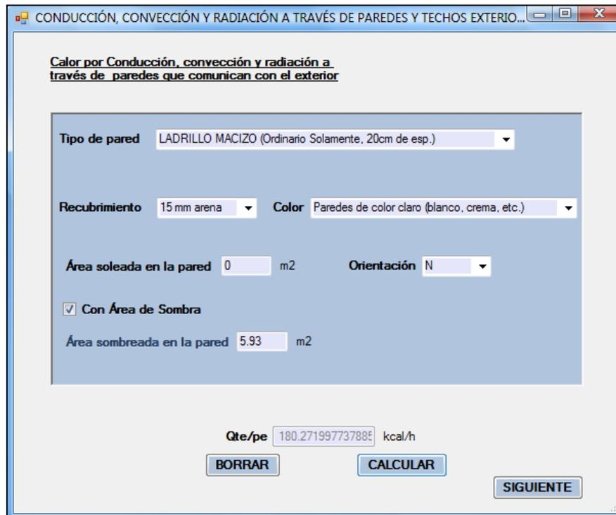
Figura N° 4.42 Conducción, convección y radiación combinada a través de paredes que comunican al exterior mostradas por la herramienta
