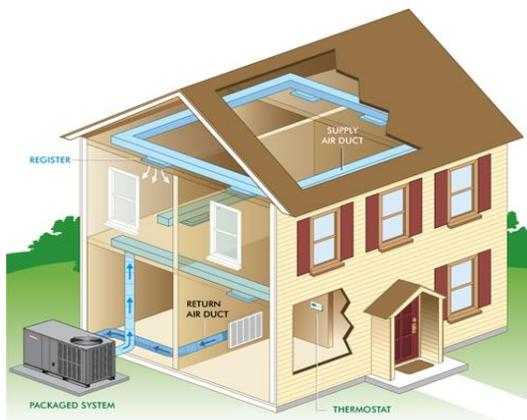
Figura N° 2.3.- Forma y distribución de conductos de aire[6]
