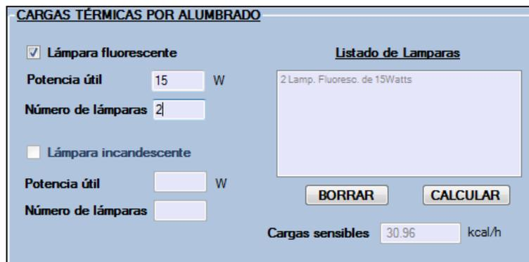
Figura N° 4.47 Cargas por alumbrado mostradas por la herramienta
