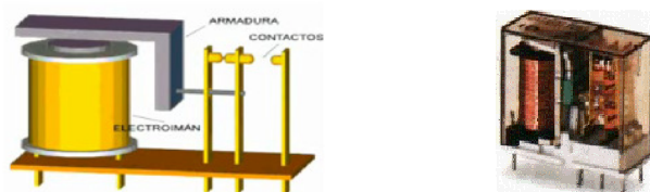
Figura 4.39. (a) Partes del Relé conmutador. ( www.youtube.com , 2009). (b) Relé conmutador. ( www.i-españa.com , 2009).
