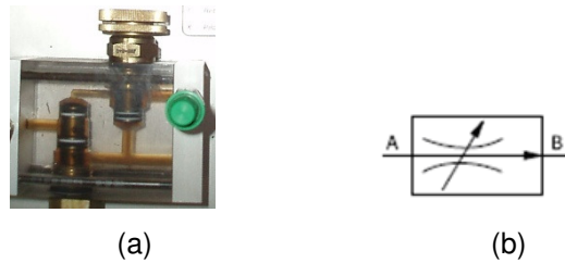
Figura 4.27. (a) Válvula reguladora de caudal de 2 vías, compensada. (b) Símbolo según las Normas DIN, de la válvula reguladora de caudal. (Barrasco, 1998)
