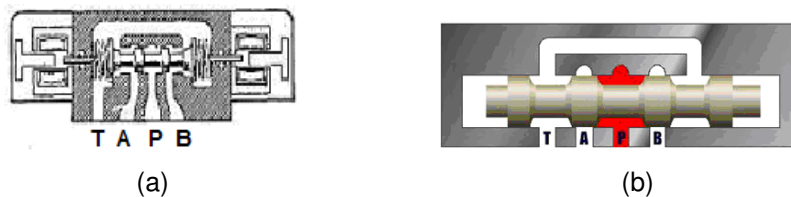
Figura 4.48. (a) Válvula 4/2 vías electro-oleohidráulica equilibrada en su centro, ( www.sapiensman.com , 2009). (b) Estructura interna de una válvula 4/3 vías de centro cerrado, (Hidráulica Básica 3, 2000)
