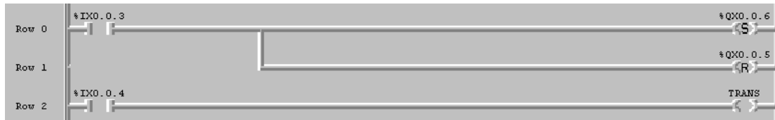
Figura 4.110. Diagrama de escalera de la etapa dos del montaje de diagrama de pasos utilizando el lenguaje SFC
