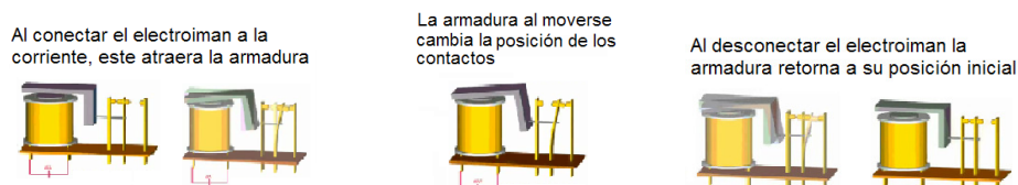
Figura 4.40. (a) Accionamiento del electroimán cuando pasa corriente a través de él. (b) Posición del relé cuando éste está accionado. (c) Desconexión de la corriente a través del electroimán. ( www.youtube.com , 2009)
