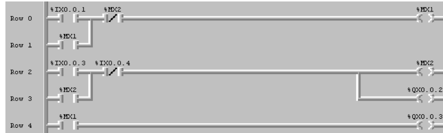
Figura 4.115. Diagrama de escalera del sistema de control electro-oleohidráulico considerando la presión
