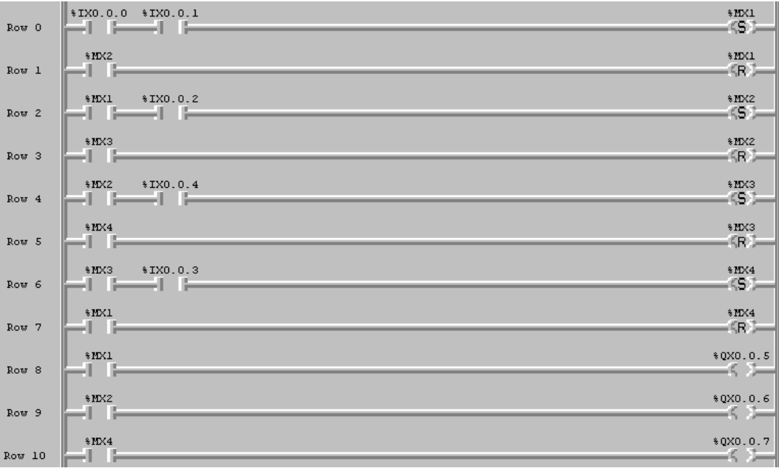
Figura 4.106. Diagrama de escalera del Diagrama de pasos (PLC LG)
