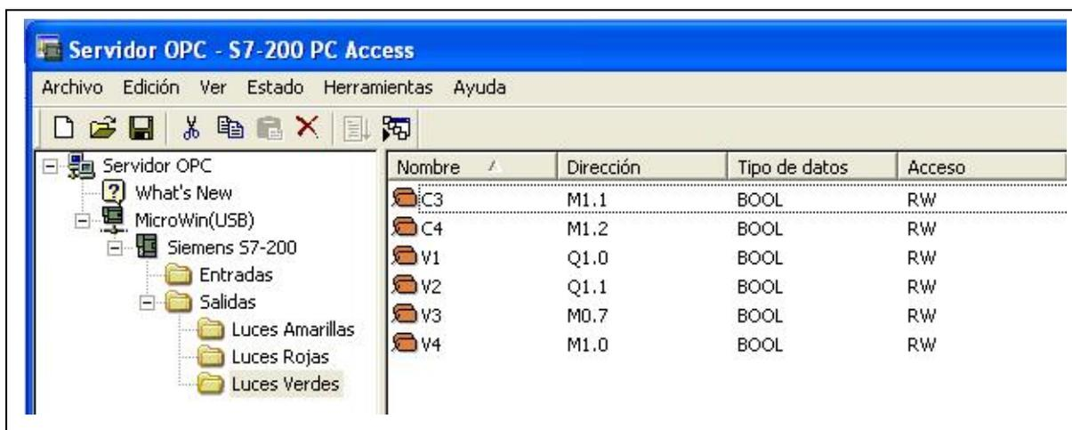
Figura 4.23 Variables de salida (Luces Verdes). Fuente: PC Access
