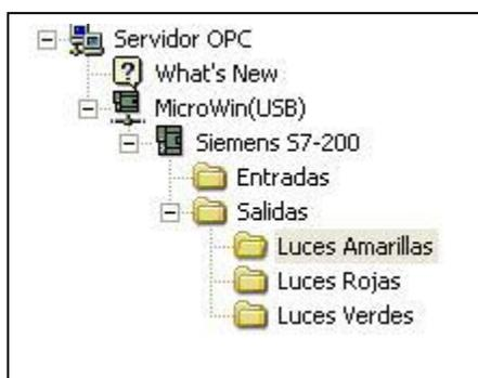
**Figura 4.19** Carpetas creadas en el servidor OPC. Fuente: PC Access
