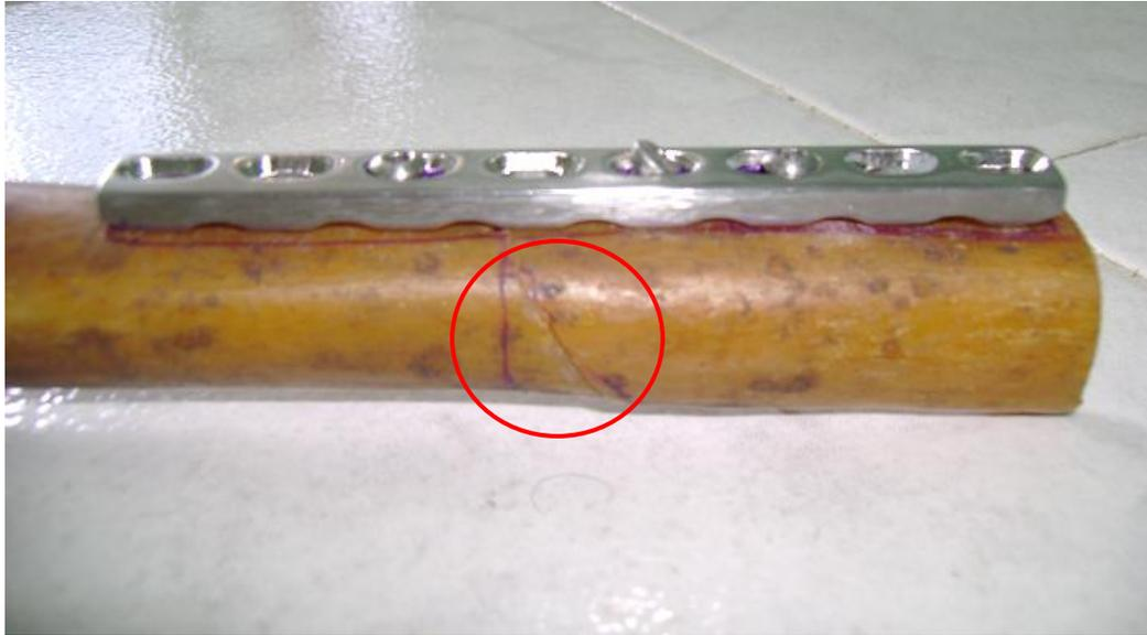
**Figura 6.4. Fractura del antebrazo después de la compresión**
