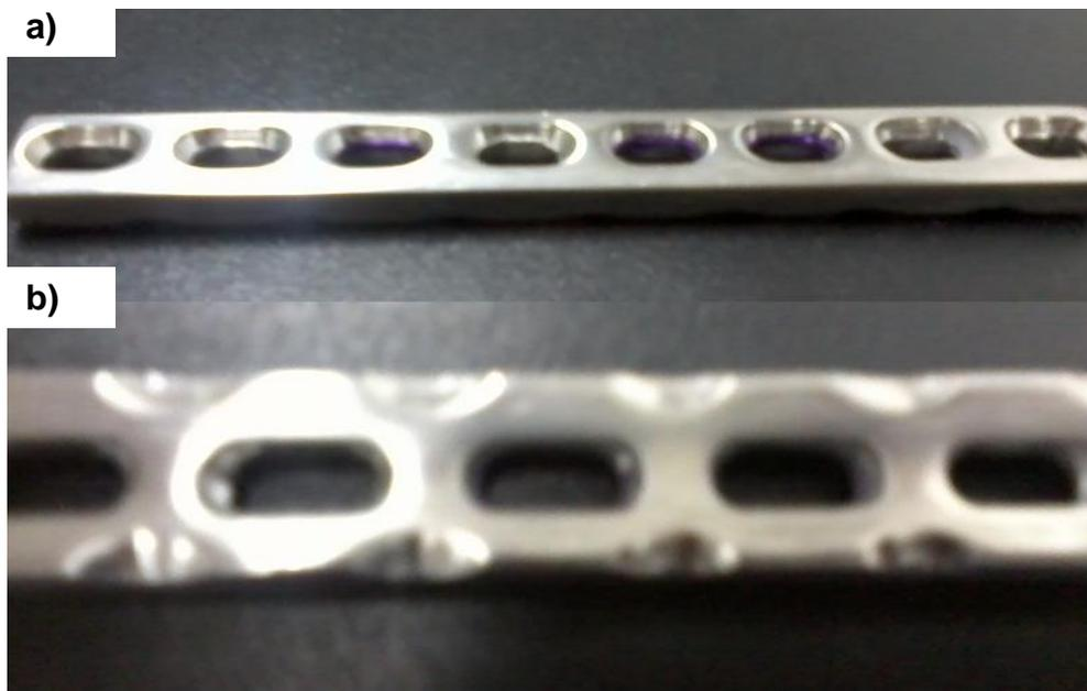
Figura 6.1. Modelo de placa LC-DCP fabricada para el ensayo. (a) Vista superior, (b) Vista inferior
