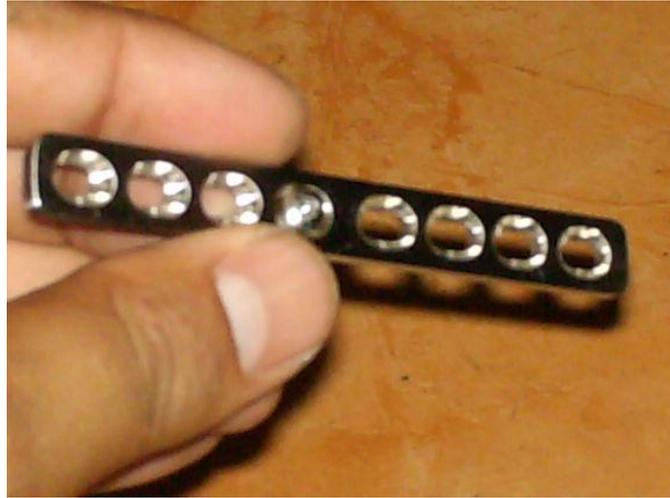
**Figura 6.1. Modelo construido de la placa para fijación de fractura de tibia**
