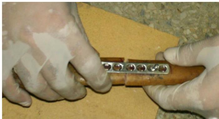
**Figura 6.4. Colocación de un tornillo en el otro extremo de la placa**
