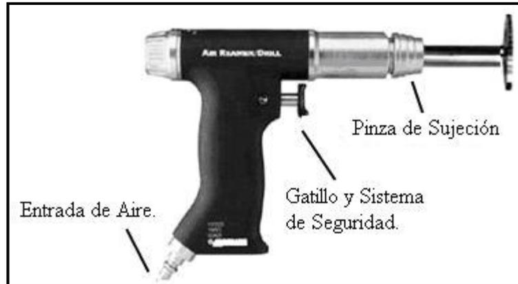
*Figura 2.- Sierra de disco (accionamiento neumático)*
