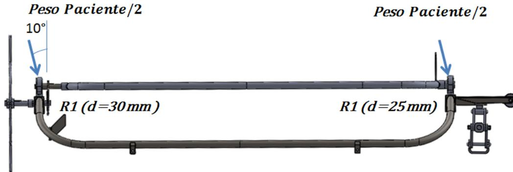
Figura 4.32 Condiciones de carga para el arreglo de rodamientos de la camilla
