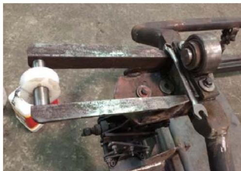
Foto 4.8 Pieza guía para el hilo conectado al compás
