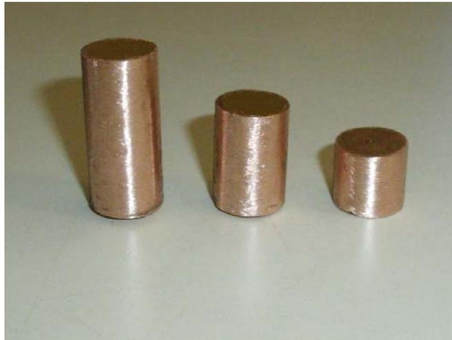
**Figura 3.2.** Probetas de cobre a distintas relaciones de esbeltez.
