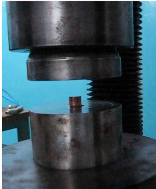
**Figura 3.7.** Ensayo de compresión.
