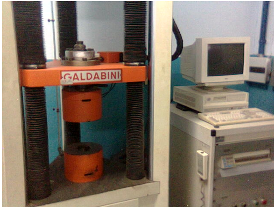
Figura 3.3 Máquina de ensayo de tracción (GALDABINI)
