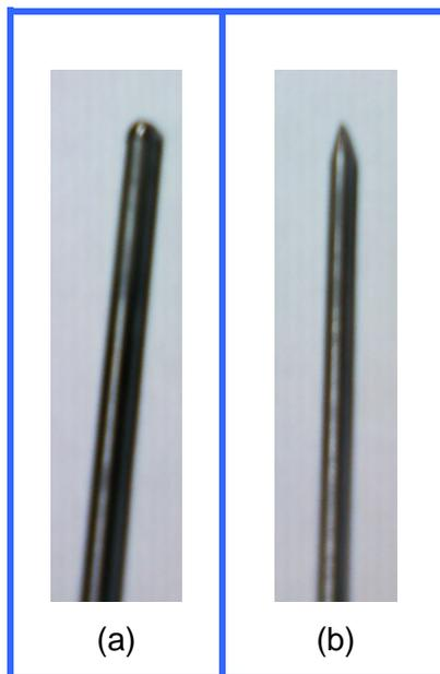
**Figura 3.4** Varilla de Tungsteno. a: Antes, b: Después
