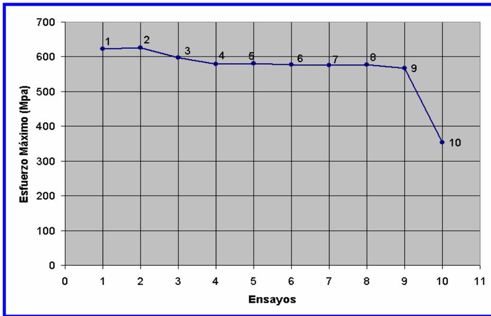
**Figura 4.4** Esfuerzo Máximo vs. Número de Ensayos
