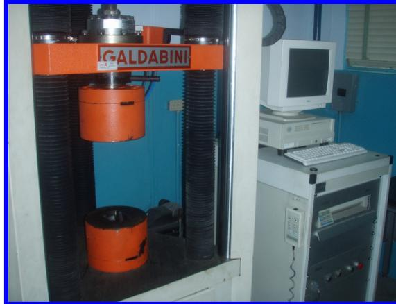
**Figura 3.12** Máquina de ensayo a tracción
