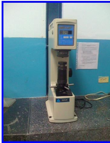
**Figura 3.15** Máquina de Ensayo de Dureza.
