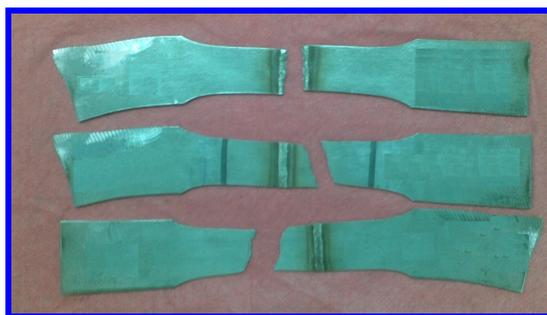
**Figura 4.2** Probetas de tracción de acero inoxidable 304 para el ensayo de soldadura a 120A y 14 L/min.
