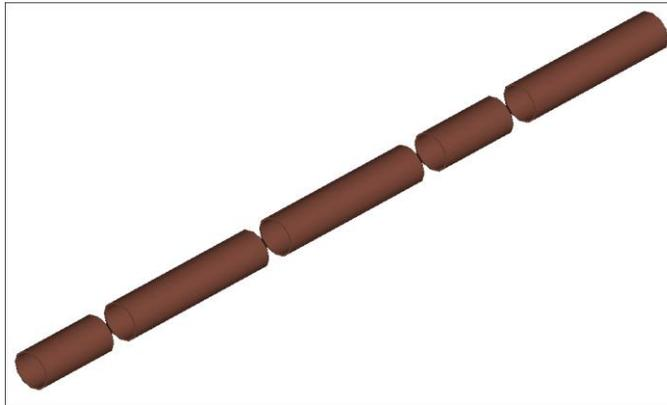
**Figura 3.1. Representación de los anillos para las probetas de tracción obtenidos mediante el corte de los tubos.**
