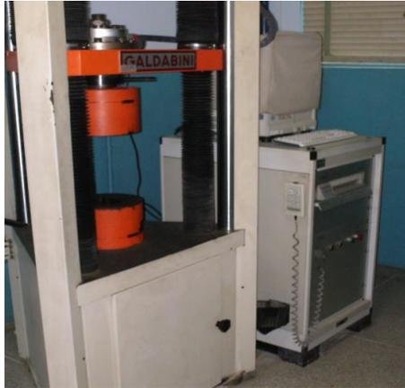
**Figura 3.11. Máquina Universal de Ensayos Mecánicos utilizada.**
