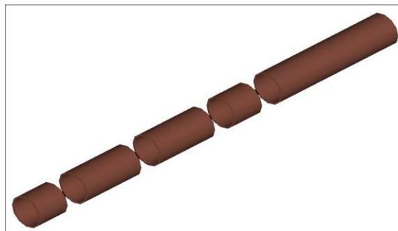
**Figura 3.2. Representación de los anillos para las probetas de dureza y metalografía obtenidos mediante el corte de los tubos.**
