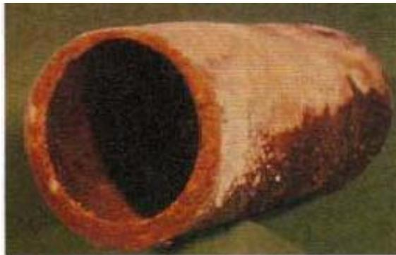
**Figura 1.1. Tubería de caldera corroída.**
