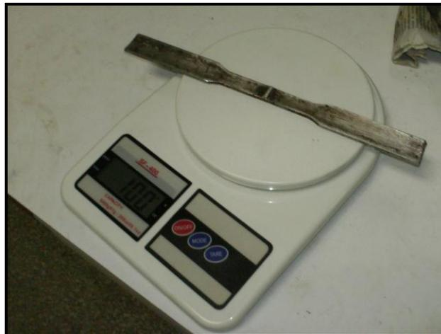
**Figura 4.21. Pesaje de una probeta antes de ser sometida a corrosión.**
