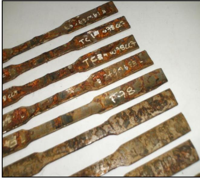
**Figura 4.23. Resultado de las muestras expuestas a corrosión durante siete (7) días.**
