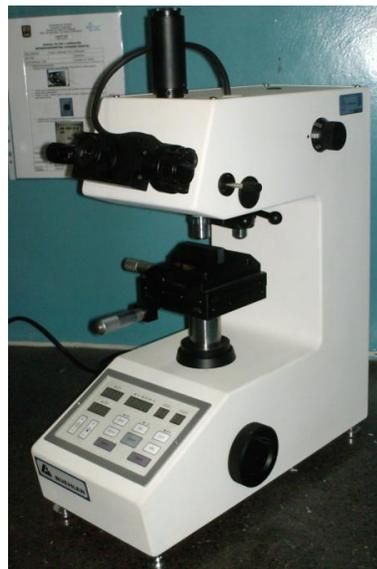
**Figura 3.15. Microdurómetro utilizado en los ensayos.**
