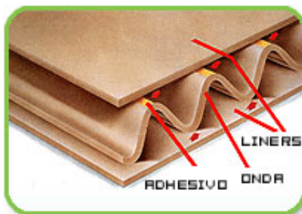
Fig. 2.1 Componentes del Cartón Corrugado.
