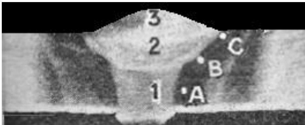
Figura 4.1 Puntos A, B y C seleccionados para el estudio de la microdureza
