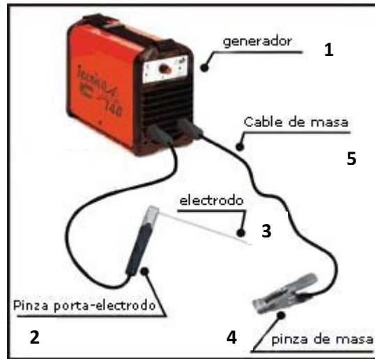
Figura 2.2 Equipo utilizado en la soldadura por arco eléctrico. Fuente: Microsoft Encarta
