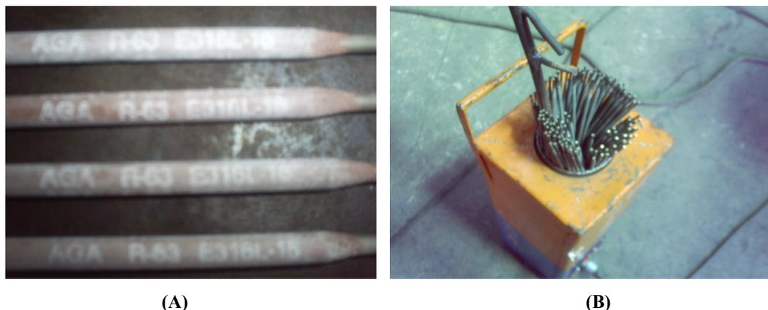
**Figura 3.6. A: Electrodos utilizados durante el proceso de soldadura. B: Horno térmico para electrodos portátil.**
