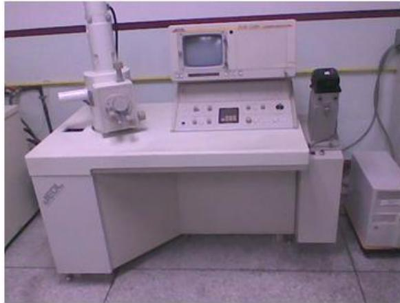
**Figura 3.10** Microscopio electrónico de barrido
