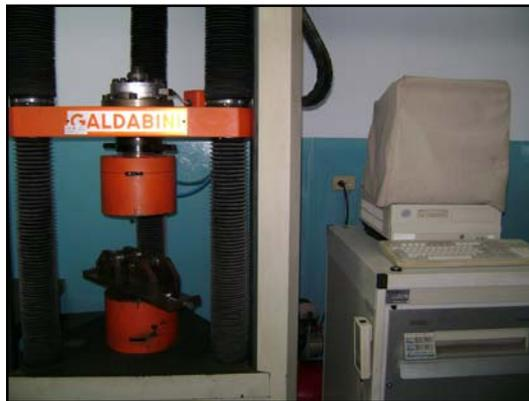
*Figura N° 3.8 Máquina para Ensayo de Tracción*
