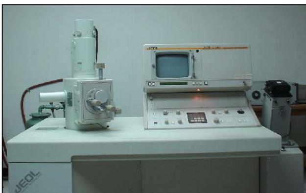
*Figura N° 3.14 Microscopio Electrónico de Barrido.*
