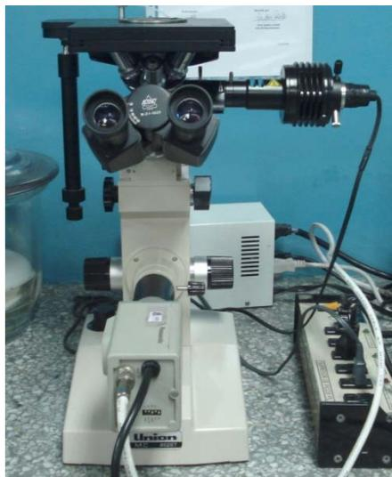
*Figura N° 3.13 Microscopio Óptico Union MC – 86267*
