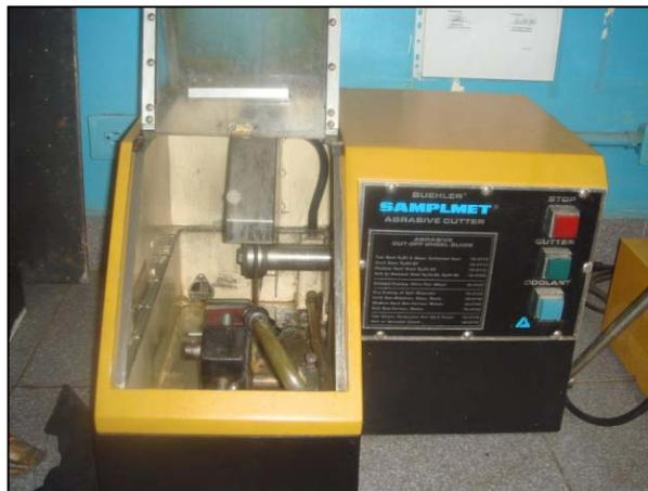
*Figura N° 3.10 Cortadora Metalográfica*
