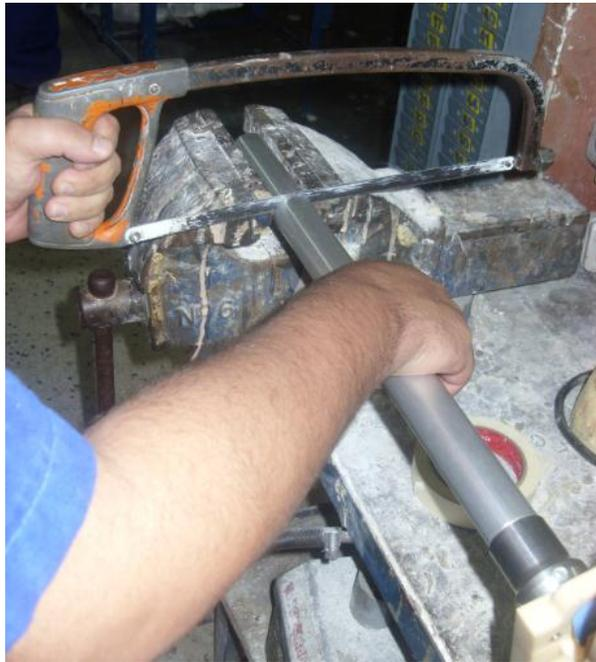
**Figura 6.7. Corte del tubo**
